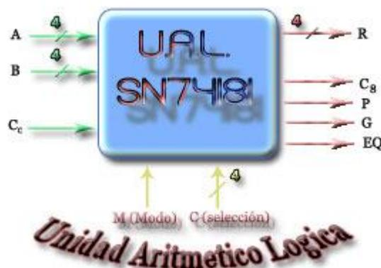
Una de las UAL's integradas que más se emplea es el circuito integrado SN74181 que contiene las siguientes entradas:
