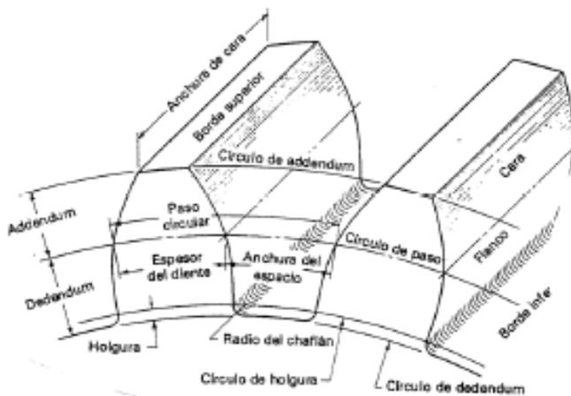
Fig 1: Nomenclatura de un engranaje.
